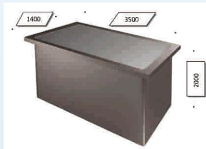
Kotlar vrši vruće pocinčavanje materijala uz upotrebu centrifuge: vijaka, matica, podložaka, ovjesne i spojne opreme i slično.
