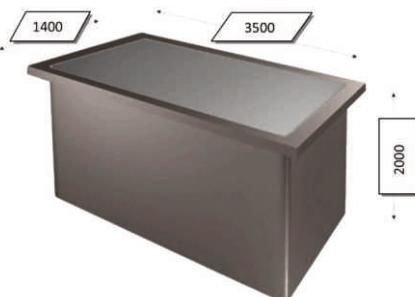
Kotlar vrši vruće pocinčavanje materijala uz upotrebu centrifuge: vijaka, matica, podložaka, ovjesne i spojne opreme i slično.
